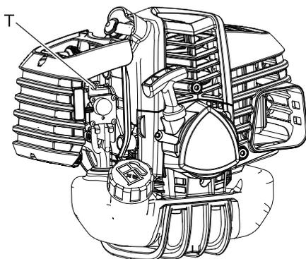
Jedes Gerät wird werkseitig einem Probelauf unterzogen, bei dem der Vergaser auf optimale Leistung eingestellt wird.
