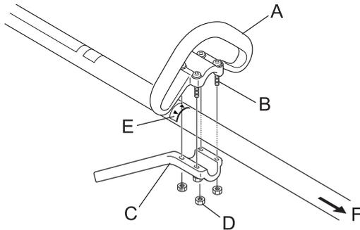
Befestigen Sie den Rundgriff (A) und die Halterung (C) am Antriebswellenrohr.
