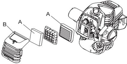
1. Schließen Sie den Choke. Lösen Sie die Verriegelung der Luftfilterabdeckung und entfernen Sie die Luftfilterabdeckung (B).
