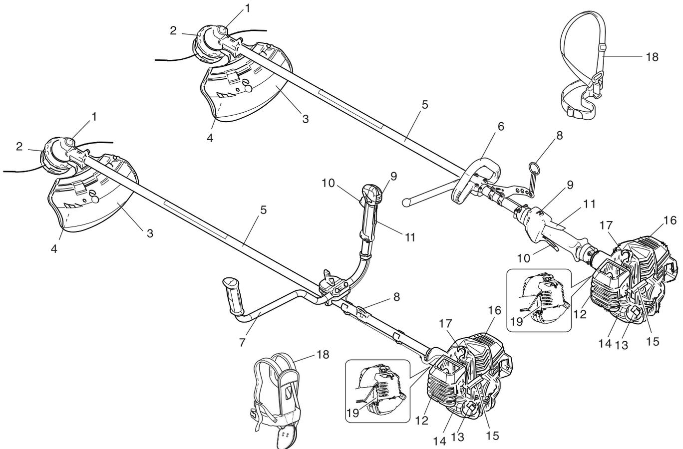
1. **Winkelgetriebe** Ermöglicht es, den Winkel der Rotationsachse zu ändern.
