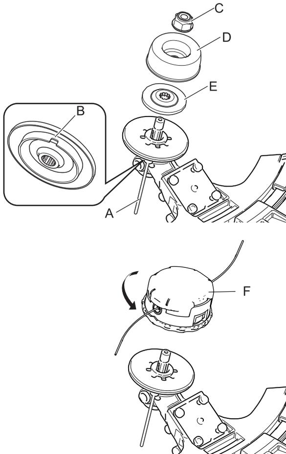
1. Stecken Sie das Arretierwerkzeug (A) in das Loch auf der rechten Seite des Winkelgetriebes. Drücken Sie dabei die Rückhaltefeder nach links.
