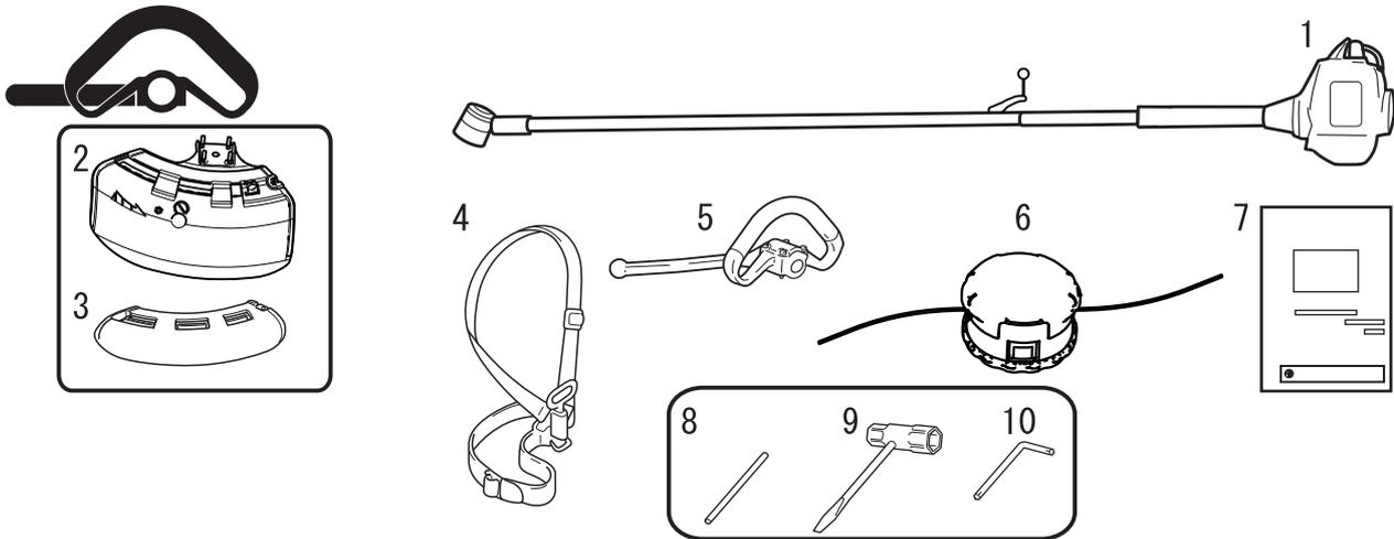
1. Motor und Antriebswellenrohr
