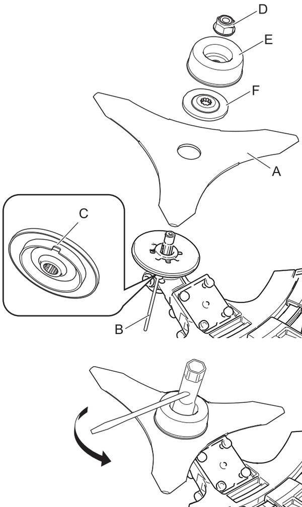
1. Kontrollieren Sie die Messer (A) vor der Montage. Überprüfen Sie die Schärfe. Bei stumpfen Messern erhöht sich das Risiko eines Rückschlags. Kleine Risse können sich zu Brüchen entwickeln, so dass Teile des Messers während des Betriebs weggeschleudert werden. Entsorgen Sie gerissene Messer, egal, wie klein der Riss ist.
