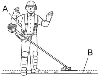
Gerät so ausbalancieren, dass der Schneidkopf parallel zum Boden steht
