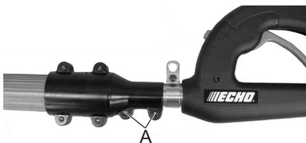
4. Richten Sie das flexible Verbindungselement der Antriebswelle mit dem Steckschlüssel der Antriebswelle aus, und schieben Sie diese so lange zusammen, bis die Griffbaugruppe vollständig in der Antriebswelle sitzt.
