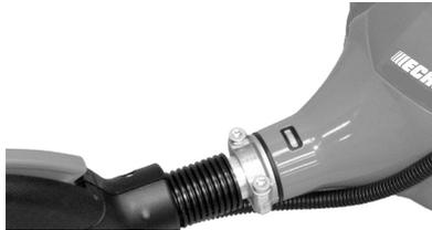
2. Ziehen Sie das Verbindungselement der Antriebswelle 51 bis 76 mm aus der Antriebswellenbaugruppe heraus.
