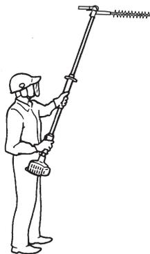
Wenn nach dem Starten des Motors der Gashebel betätigt wird, erhöht sich die Motordrehzahl, und die Messer setzen sich in Bewegung. Stellen Sie die Motordrehzahl je nach Aufgabe ein (z. B. entsprechend der zu schneidenden Hecke/Aststärke).
