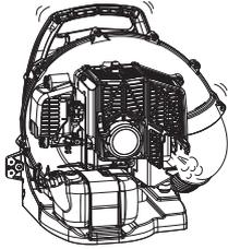
1. Sobald der Motor läuft, lassen Sie ihn 2 bis 3 Minuten im Leerlauf (niedrige Drehzahl) warmlaufen.
