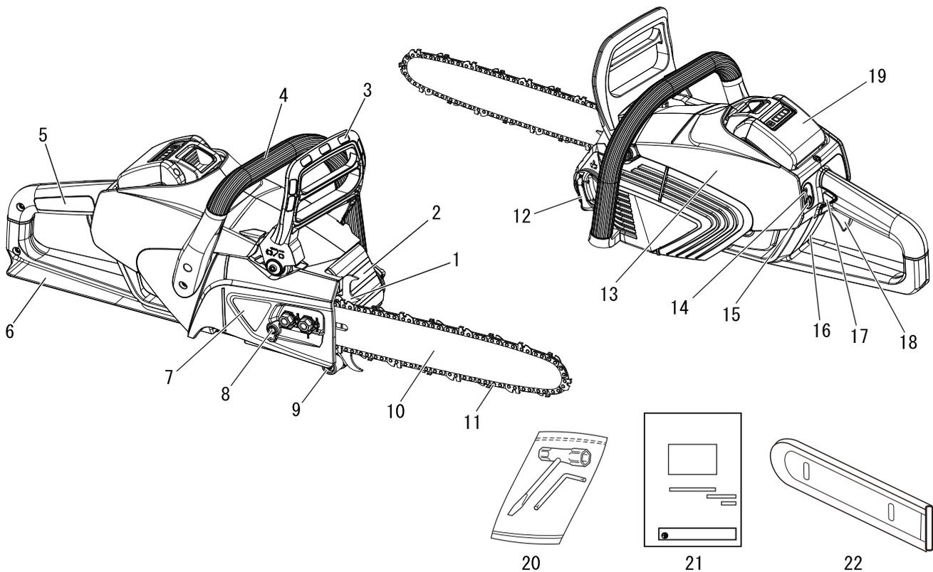
1. **Krallenanschlag** - Vor dem Befestigungspunkt des Schwerts montiertes Teil, das in Kontakt mit einem Baum oder Baumstamm als Drehpunkt dient.
