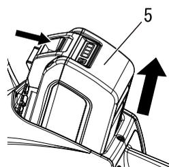
1. Lassen Sie den Hebelschalter und die Hebelschaltersperre los und die Sägekette zum Stillstand kommen.
