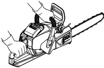
1. Füllen Sie den Kettenölbehälter mit Schmiermittel.
