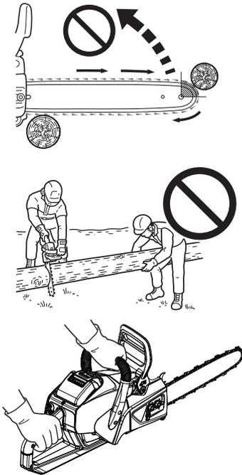
Eine Kettensäge darf immer nur von einer Person bedient werden.
