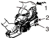
1. Lösen der Kettenbremse
