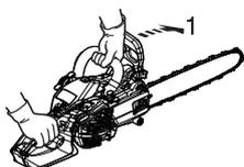
1. Position der Kettenbremse: EINGESCHALTET
