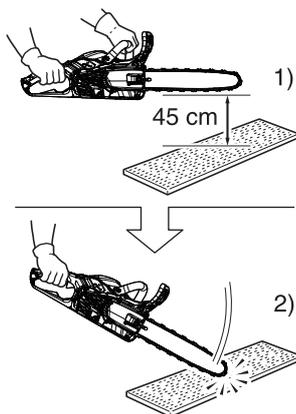
Die automatische Kettenbremse stoppt den Betrieb der Motorsäge derart, dass die am Ende der Kettenschiene erzeugte Rückschlagwirkung automatisch die Kettenbremse betätigt. Gehen Sie auf folgende Weise vor, um sicherzustellen, dass die automatische Kettenbremse richtig funktioniert:
