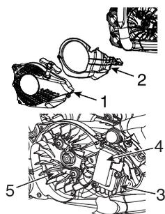
1. Reversierstarter      2. Luftführungsblech      3. Zylinderrippen
