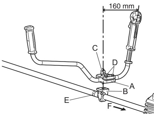
1. Setzen Sie den oberen Griffbefestigungsbacken (A) auf den unteren (B), und fixieren Sie den Griff, indem Sie den Griffhaltebolzen (C) leicht anziehen.
