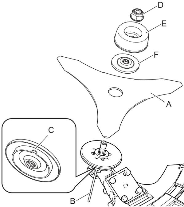
1. Kontrollieren Sie die Messer (A) vor der Montage. Überprüfen Sie die Schärfe. Bei stumpfen Messern erhöht sich das Risiko eines Rückschlags. Kleine Risse können sich zu Brüchen entwickeln, so dass Teile des Messers während des Betriebs weggeschleudert werden. Entsorgen Sie gerissene Messer, egal, wie klein der Riss ist.
