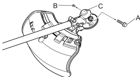
1. Bauen Sie den Stopfen (A) und die Ablassschraube (B) aus dem Winkelgetriebe (C).
