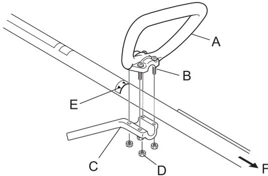
Befestigen Sie den Rundgriff (A) und die Halterung (C) am Antriebswellenrohr.
