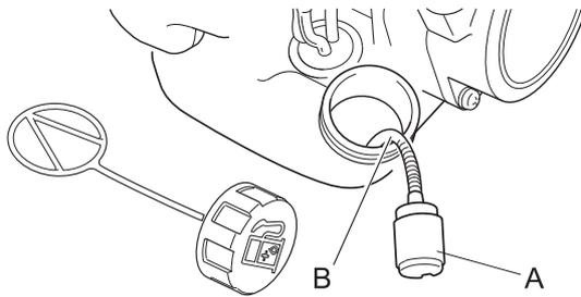
1. Ziehen Sie den Kraftstofffilter mit Hilfe eines Metalldrahts o. Ä. durch die Tanköffnung heraus.
