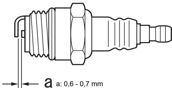
1. Prüfen Sie den Elektrodenabstand. Der korrekte Abstand beträgt 0,6 bis 0,7 mm.
