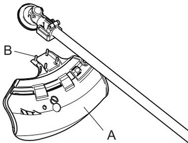
1. Befestigen Sie das Schutzschild (A) am Winkelgetriebe und ziehen Sie die 4 Schrauben (B) fest.
