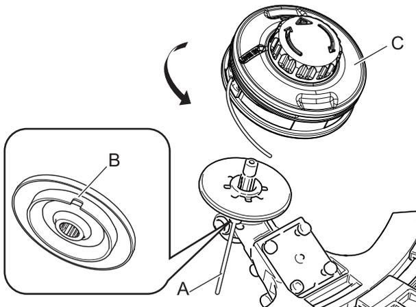
1. Stecken Sie das Arretierwerkzeug (A) in das Loch auf der rechten Seite des Winkelgetriebes. Drücken Sie dabei die Rückhaltefeder nach links.
