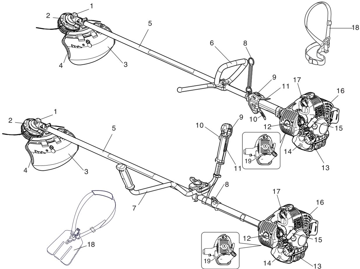
1. **Winkelgetriebe** Ermöglicht es, den Winkel der Rotationsachse zu ändern.
