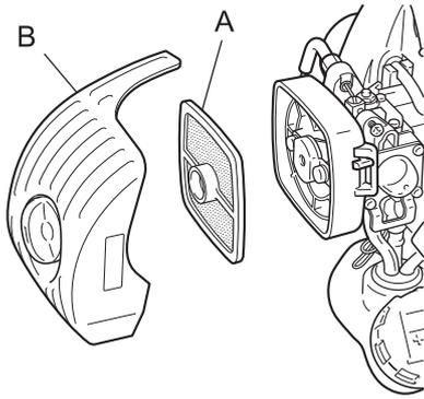
1. Schließen Sie den Choke. Lösen Sie die Verriegelung der Luftfilterabdeckung und entfernen Sie die Luftfilterabdeckung (B).
