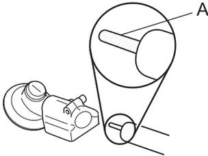
Überprüfen Sie die Antriebswelle (A) alle 100 Betriebsstunden, und schmieren Sie sie, falls erforderlich.
