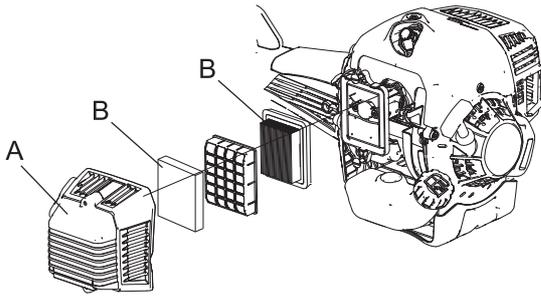
1. Schließen Sie den Choke. Lösen Sie die Schraube, und entfernen Sie die Luftfilterabdeckung (A).
