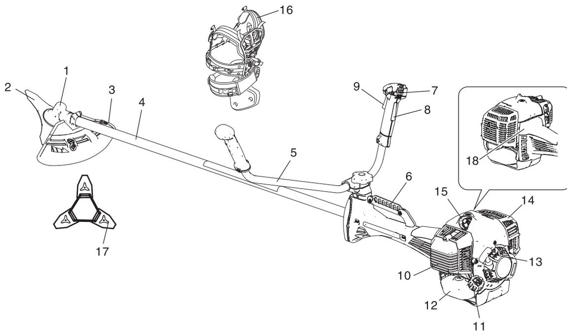
1. **Winkelgetriebe** Ermöglicht es, den Winkel der Rotationsachse zu ändern.
