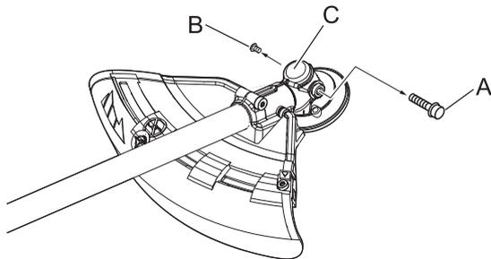
1. Bauen Sie den Stopfen (A) und die Ablassschraube (B) aus dem Winkelgetriebe (C).
