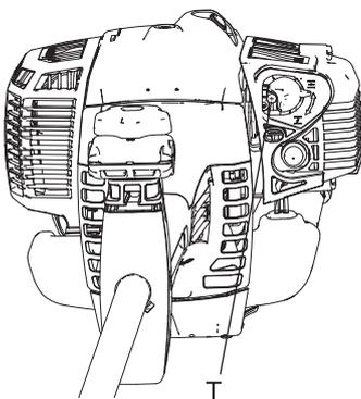
Jedes Gerät wird werkseitig einem Probelauf unterzogen, bei dem der Vergaser auf optimale Leistung eingestellt wird. Reinigen/wechseln Sie vor der Vergaserjustierung den Luftfilter, starten Sie den Motor, und lassen Sie ihn einige Minuten warmlaufen.
