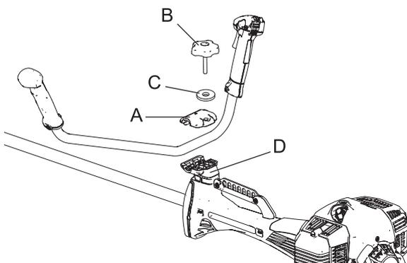
1. Setzen Sie den oberen Griffbefestigungsbacken (A) auf den unteren (D), und fixieren Sie den Griff, indem Sie den 8 mm-Griffhaltebolzen (B) leicht anziehen.
