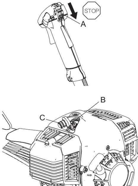
1. Entleeren Sie den Kraftstofftank vollständig im Freien, wobei sich keine feuergefährlichen Gegenstände in der Nähe befinden dürfen. Lassen Sie Kraftstoff niemals in geschlossenen Räumen ab.
