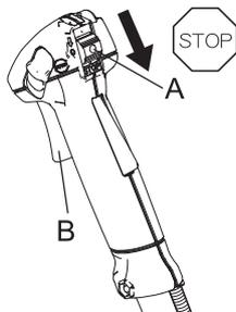
1. Stellen Sie den Gashebel (B) in die Leerlaufposition, und lassen Sie den Motor bei Leerlaufdrehzahl (niedrige Drehzahl) laufen.
